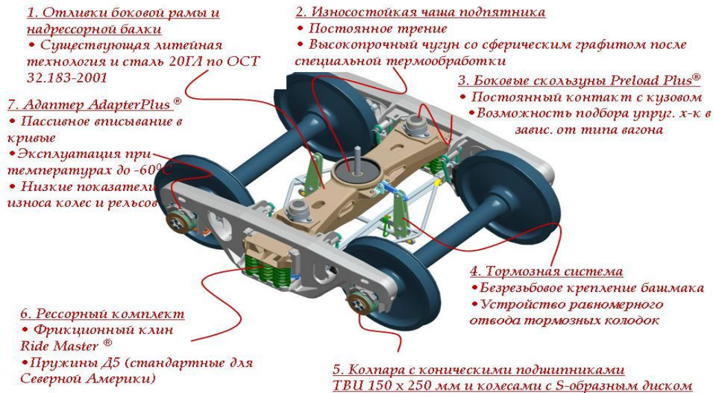
Рис. 2. Основные элементы тележки модели 18-9817
