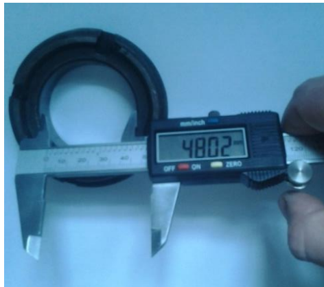
Рис. 3. Вимір внутрішнього діаметра напрямної цифровим штангенциркулем
