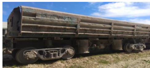
Рис. 1. Тип вантажного рухомого складу для перевезення залізрудних окатишів, який використовується ПАТ «Полтавський гірничо-збагачувальний комбінат»
