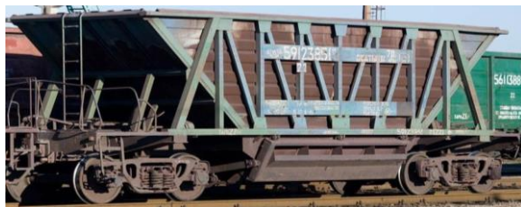
Рис. 1. Тип вантажного рухомого складу для перевезення залізрудних окатишів, який використовується ПАТ «Полтавський гірничо-збагачувальний комбінат»
