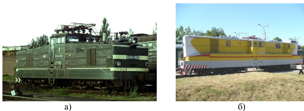
Рис. 2. Маневрові електровози розробки ДЕВЗ
