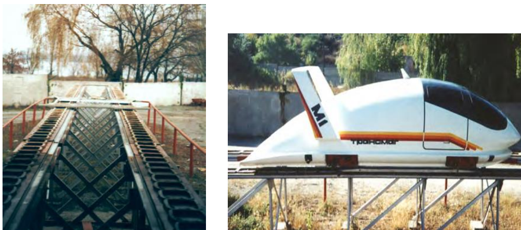
Рис. 1. Транспортна естакада з лінійним синхронним двигуном та діючий макет магнітолевітаційного транспортного засобу
