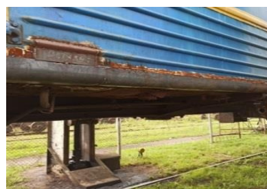
Рис. 7. Приклад ремонту елементів кузова пасажирського вагону
