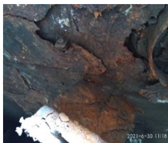
Рис. 3. Корозійні пошкодження кузова (зона 1 – підлога кузова)
