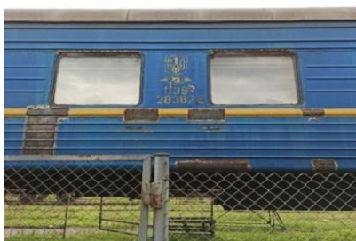
Рис. 7. Приклад ремонту елементів кузова пасажирського вагону
