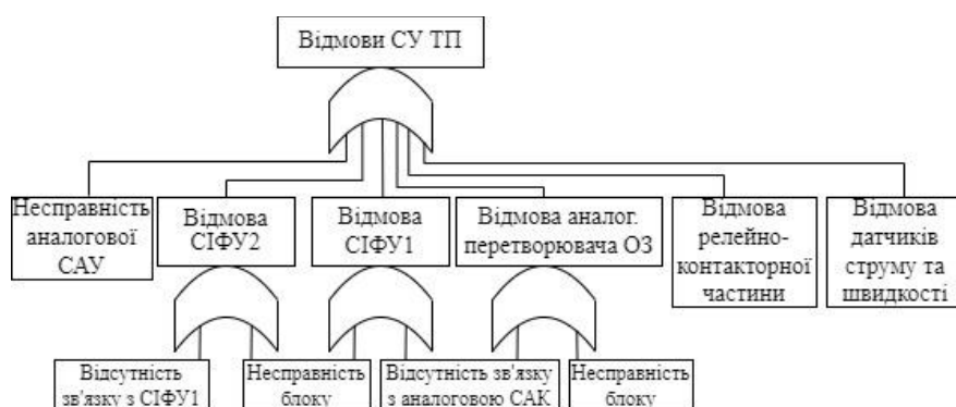
Рис. 8. Дерево відмов тиристорного перетворювача електроприводу
