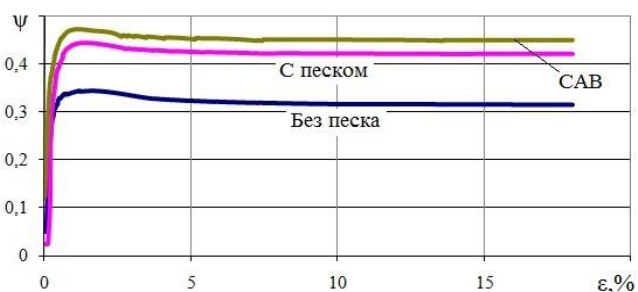
Рис. 7. Характеристики сцепления (чистые, сухие поверхности)
