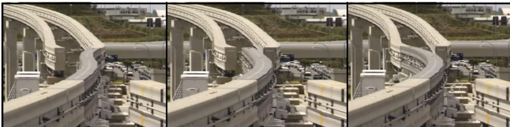
Рис. 9. Переключение гибкой монорельсовой системы, стрелочный блок в трех разных положениях
