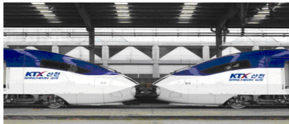
Рис. 3. З'єднання двох поїздів KTX-Sancheon за допомогою системи Шарфенберга компанії Voith
