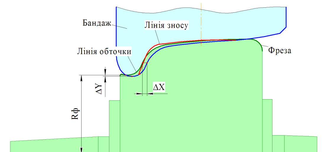
Рис. 5. Схема неповного обточування зношеного профілю «МІНТЕК»
