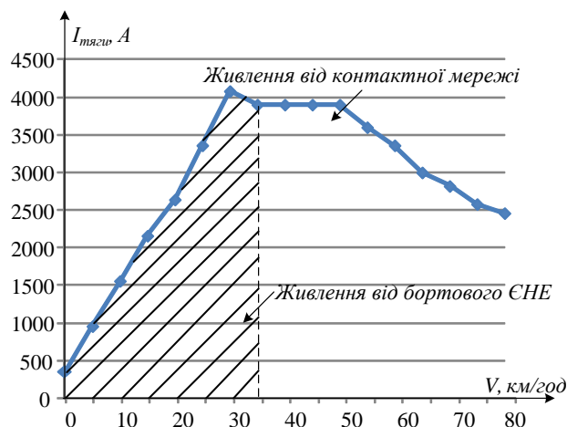
Рис. 8. Струм споживання електрорухомим складом в режимі тяги з використанням третьої концепції
