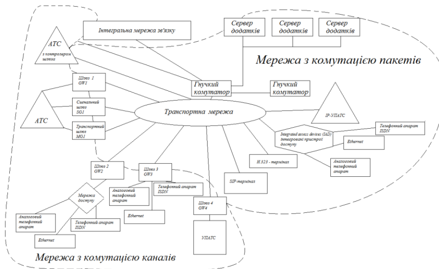
Рис. 1. Загальна архітектура мережі на основі рішень NGN [2]
