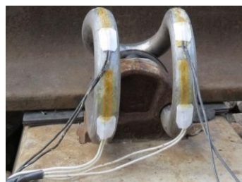
Рис. 1. Схема встановлення датчиків на клему типу КП-5 проміжного рейкового скріплення типу КПП-5
