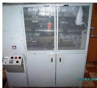
Рис. 1. Схема та загальний вид секторного пресу для виготовлення зразків асфальтобетону
