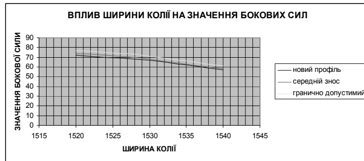
Рис. 7. Вплив ширини колії на значення бокових сил
