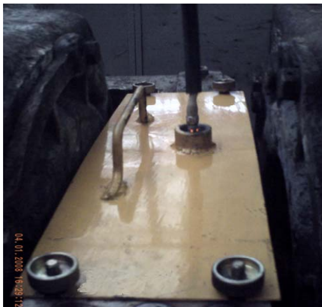
Рис. 4. Встановлення захисного кожуха із вмонтованим індуктивним датчиком
