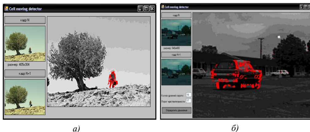
Рис. 7. Робота ПЕ з використанням порогового рівня для відсіювання «однакових» кодів сірого відтінку
